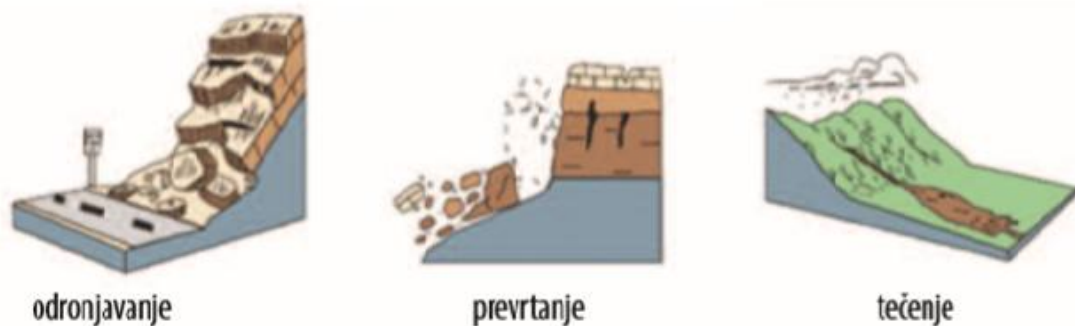
Slika 16: Prikaz osnovnih tipova klizanja prema mehanizmu kretanja
